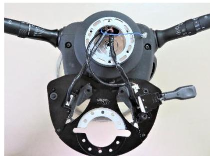
9、ラフィックス II 又は GTC 操作の妨げにならないようウイングの位置を決め、7、で仮締めした⑤サラ CAP ボルト M5×10 を 4 本増し締めしてください。
